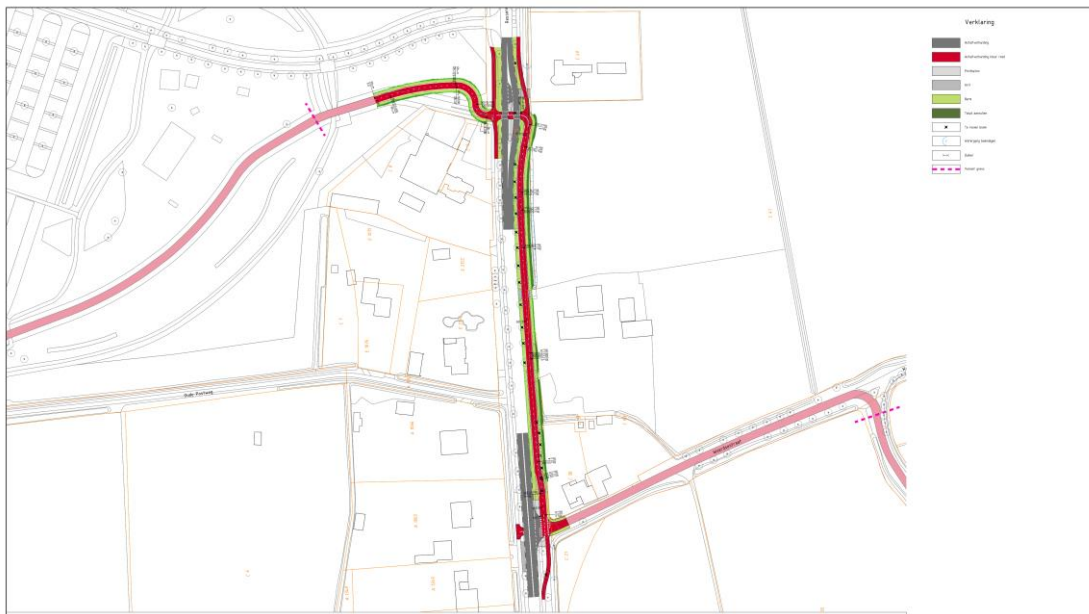
Afbeelding 2 Variant 1; gelijkvloerse oversteek, uit de voorrang in het bestaande tracé
