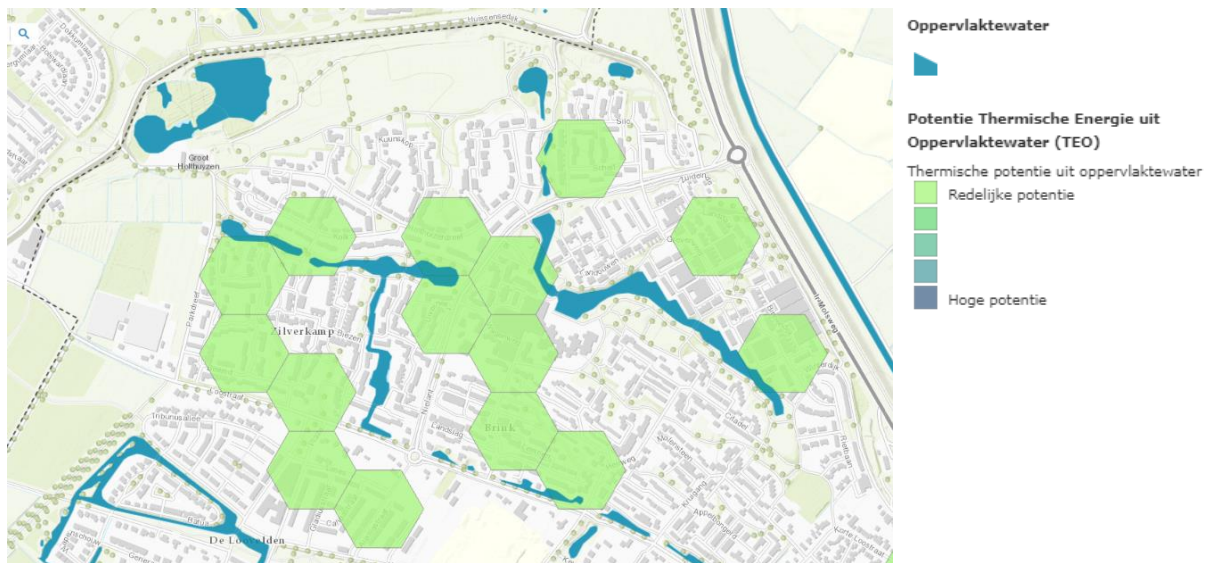
Figuur 4.4: Potentie voor thermische energie uit oppervlaktewater omgeving Silverkamp
